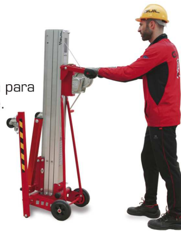
2 Estabilizadores de refuerzo para una mayor resistencia.
