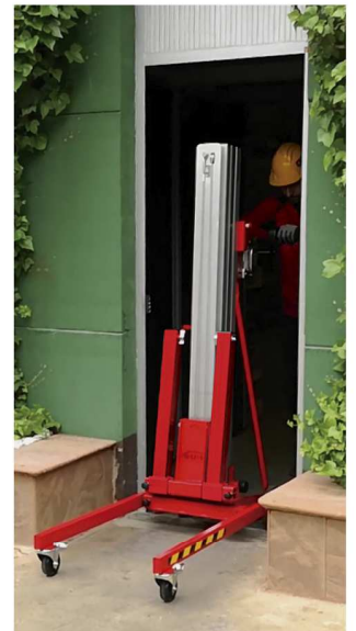
Sistema ajustable de bloqueo de los perfiles para el transporte en horizontal.
